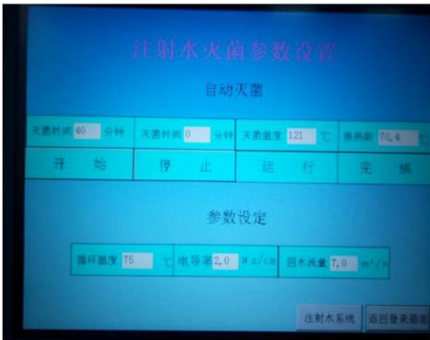
分配系统注射用水灭菌参数设置显示
