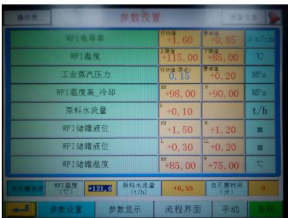
分配系统注射用水灭菌参数设置显示
