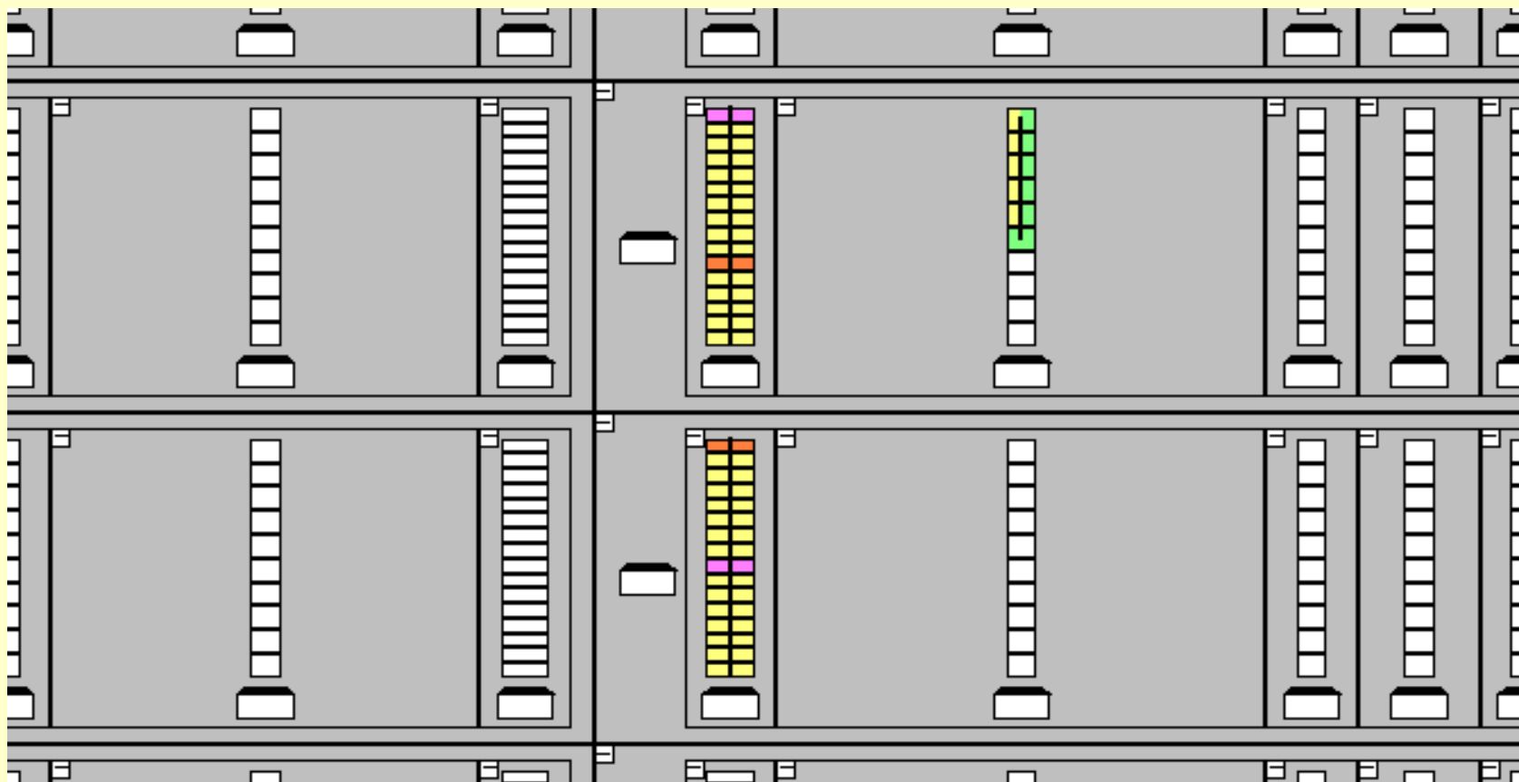
图11-21在floorplan中可以看到使用了32个ESB
