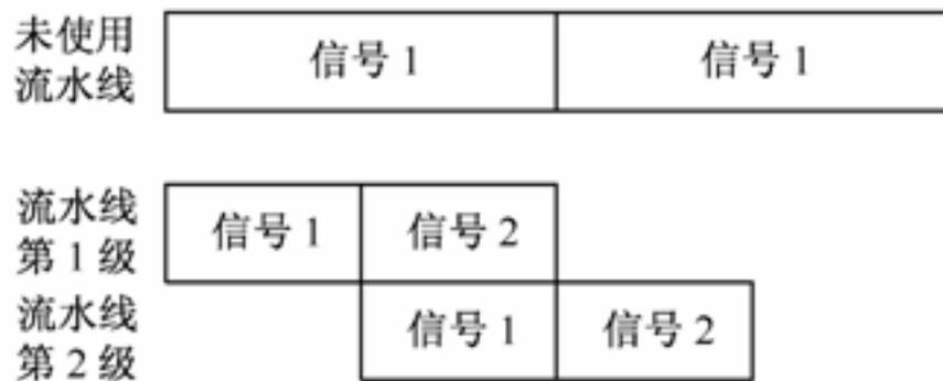
图 7-6 流水线工作图示
