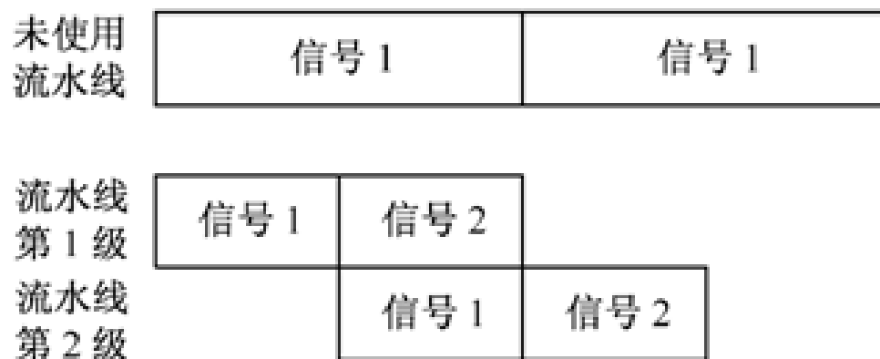
图 6-24 流水线工作图示
