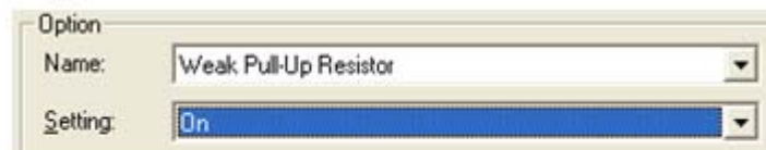
图 6-34 设置端口上拉
