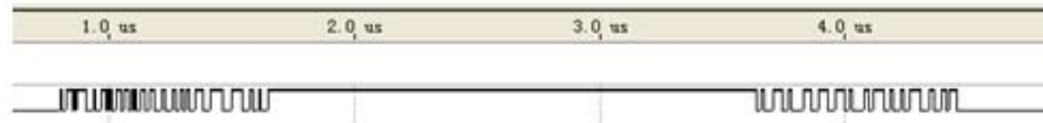
图 6-21 在信号上升与下降都含随机干扰抖动信号的时钟信号
