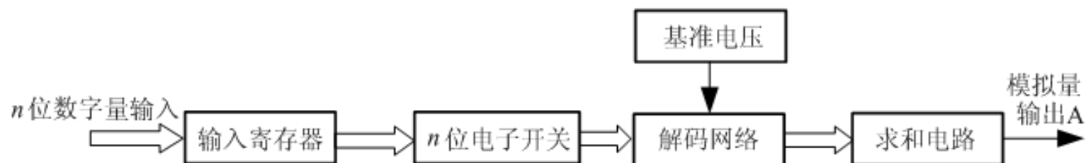
图 10-2 D/A 转换器的电路结构框图
