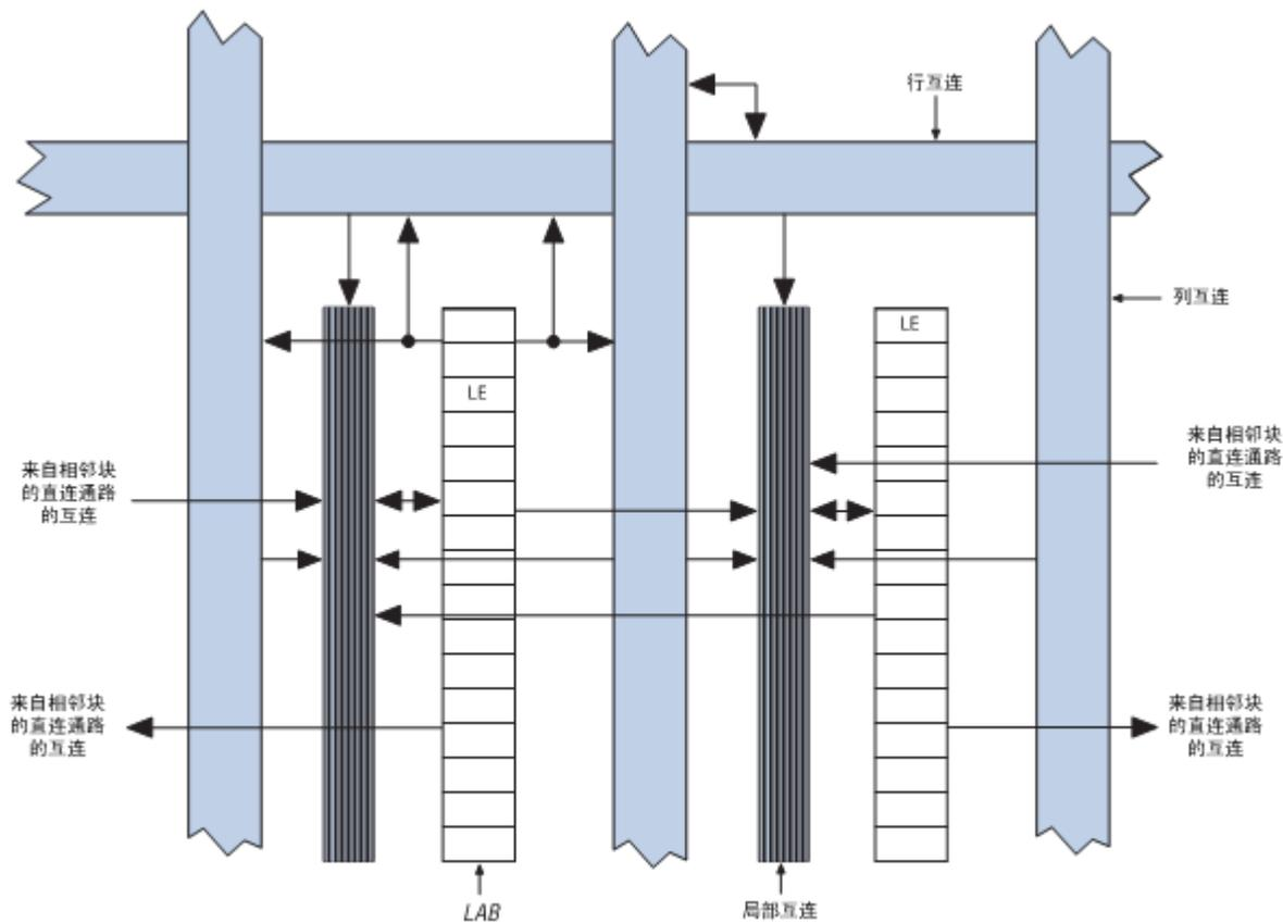
图 2-35 Cyclone III LAB 结构
