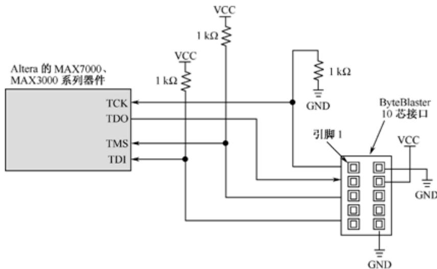
图 2-41 CPLD 编程下载连接图
