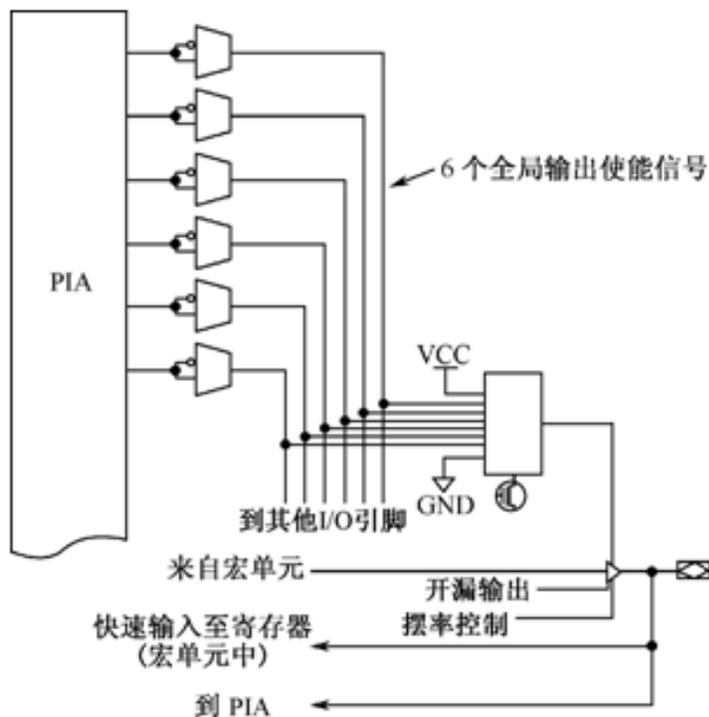
图 2-29 MAX3000A 系列器件的 I/O 控制块
