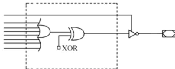
图 2-22 复合型组合输出结构
