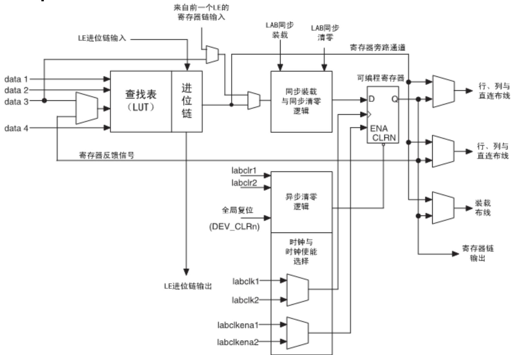
图 2-32 Cyclone III LE 结构图
