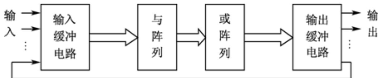
图 2-1 基本PLD器件的原理结构图
