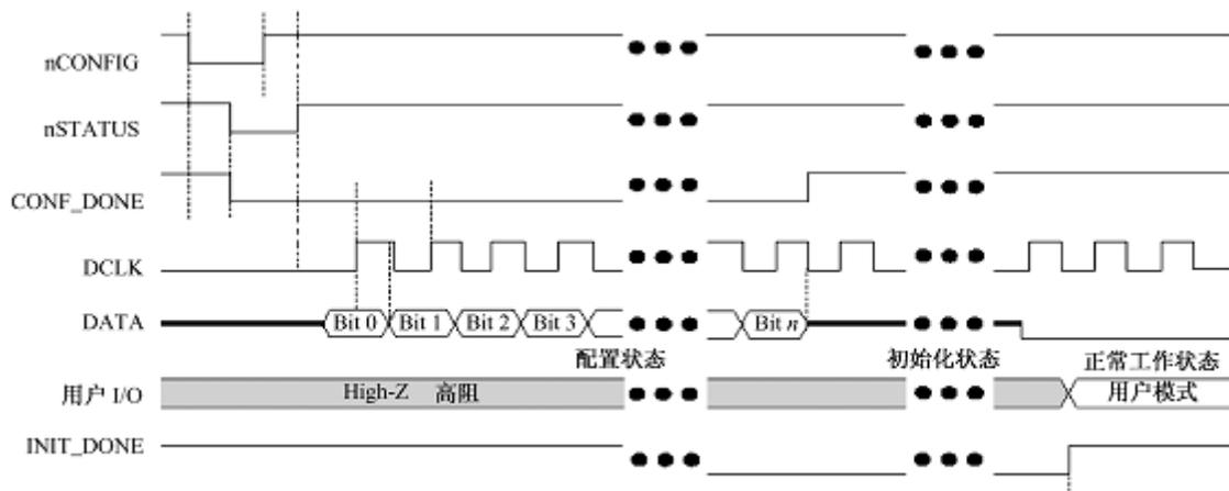
图 2-44 PS 模式的 FPGA 配置时序
