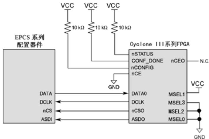
图 2-43 EPCS 器件配置 FPGA 的电路原理图
