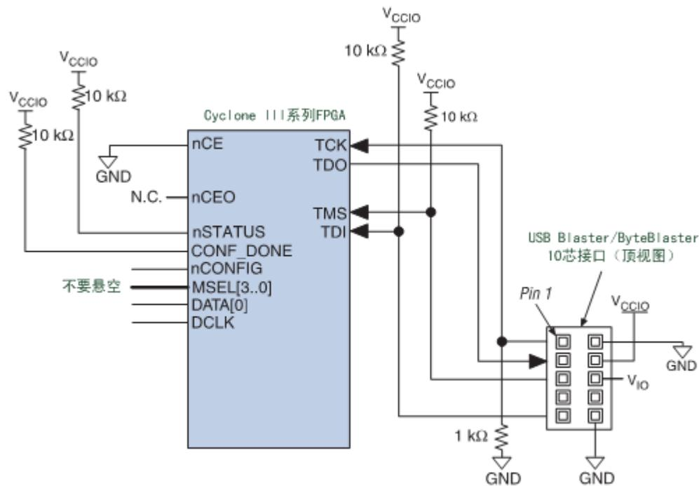
图 2-42 JTAG 在线配置 FPGA 的电路原理图
