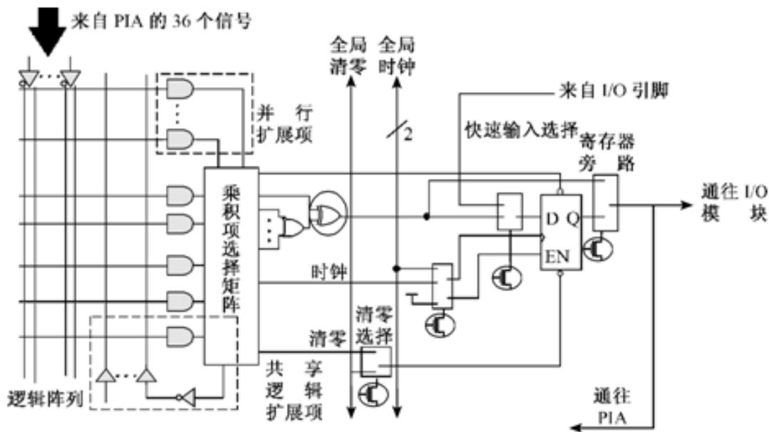
图 2-26 MAX3000A系列的单个宏单元结构
