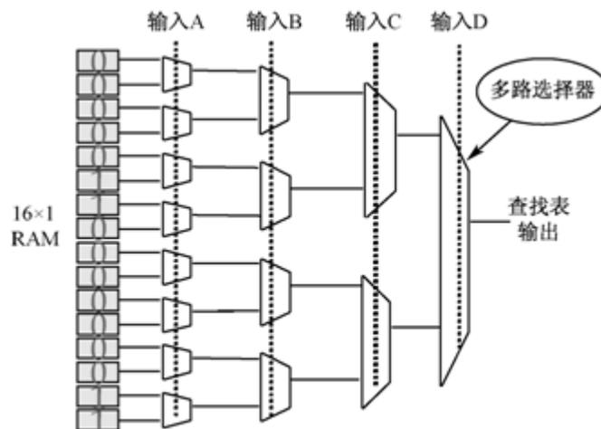
图 2-31 FPGA 查找表单元内部结构
