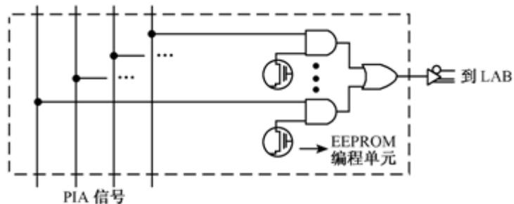
图 2-28 PIA 信号布线到 LAB 的方式
