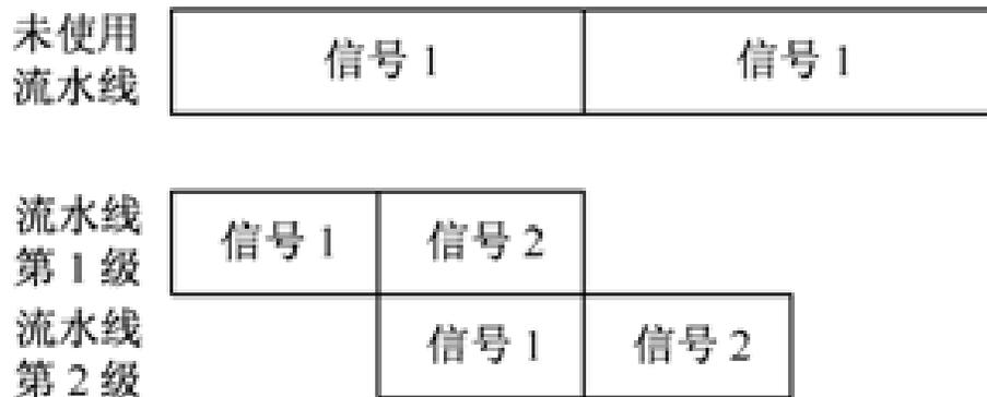
图 9-6 流水线工作图示
